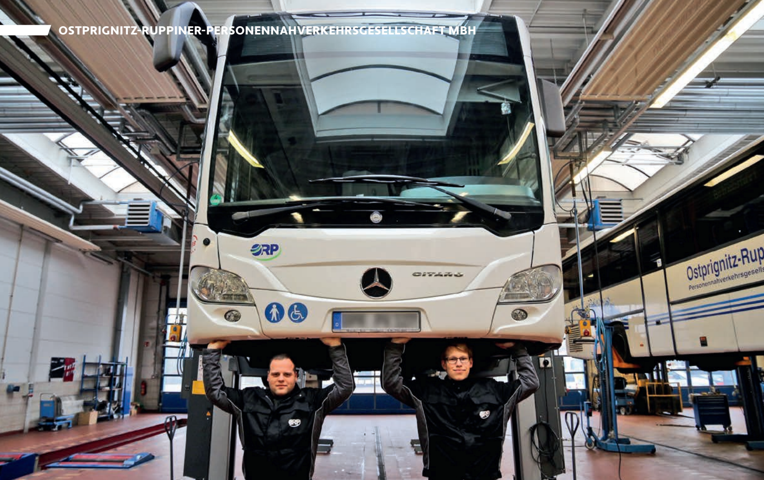
■ Starkes Stück: Um die 11 Tonnen Leergewicht hat so ein Bus ja nach Ausführung. Aber Uwe Ruschmeyer (l.) und Mario Ponath müssen ihn nicht selbst anheben, dafür gibt es spezielle Wagenheber (Radgreifer).
